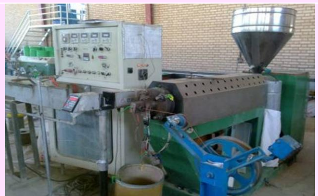
شکل ۵ دستگاه اکسترودر قديمي به همراه ترموستات ها و کنترل پنل مربوطه
